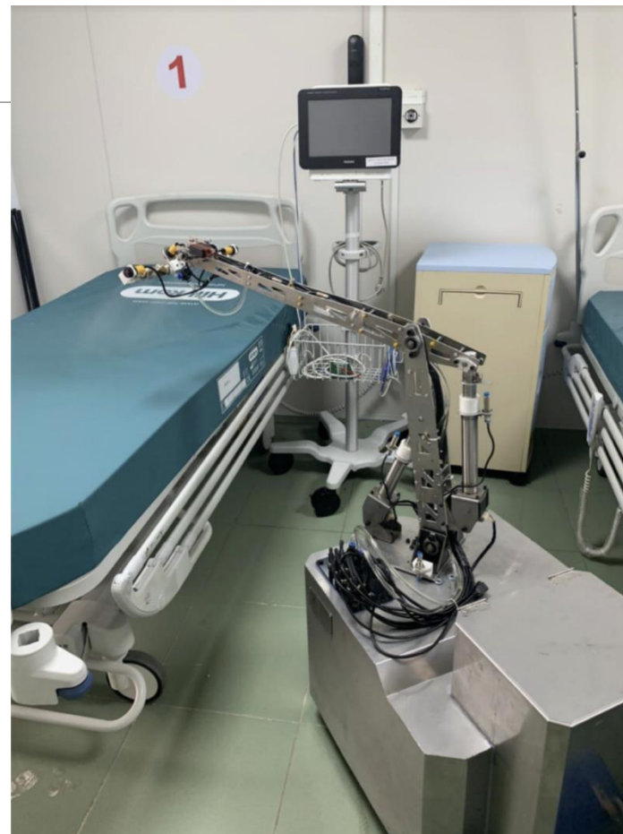
Robot khử khuẩn phòng cách ly tại các bệnh viện điều trị COVID-
