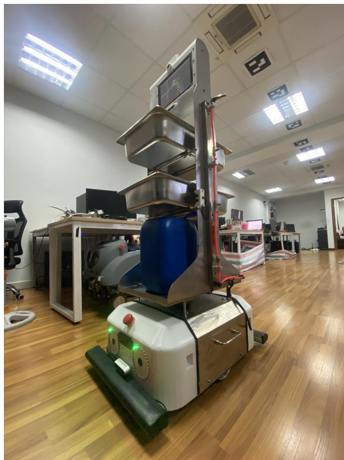
Robot chuyển đồ cho người bệnh trong các khu cách ly COVID
