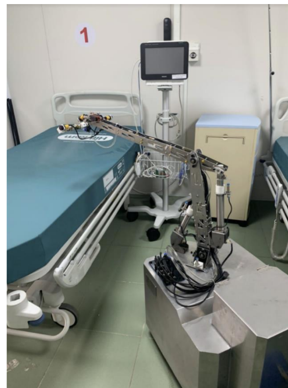
Robot khử khuẩn phòng cách ly tại các bệnh viện điều trị COVID-19
