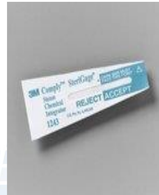
Bảng 4c. Kiểm soát chất lượng TK từng gói DC bằng Test chỉ thị hóa học đa thông số.
